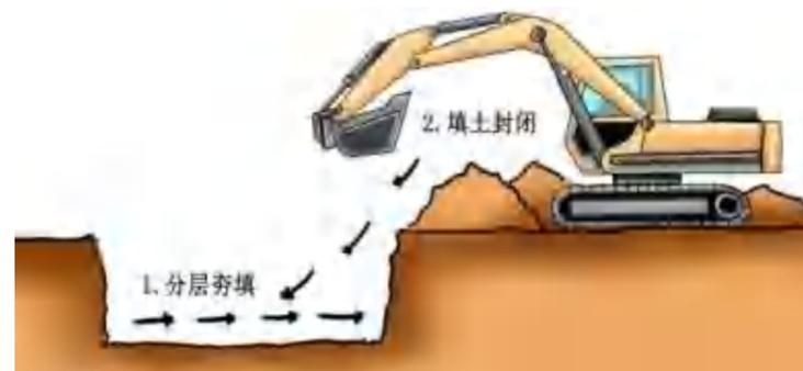
坡填方作业应由下至上分层夯填，且坡面形成后应及时封闭
